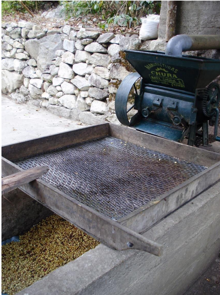
Despulpadora manual de granos de café de origen peruano. Los granos de la cesta ya han sido despulpados. (crédito: C Schwab)
